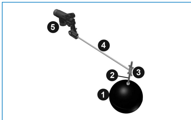
Estrutura da válvula de reposição
