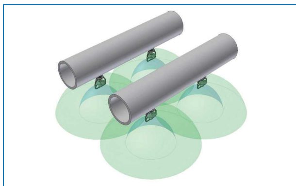
Tipo de distribuição do pulverizador de bocal para torres de refrigeração de circuito fechado
